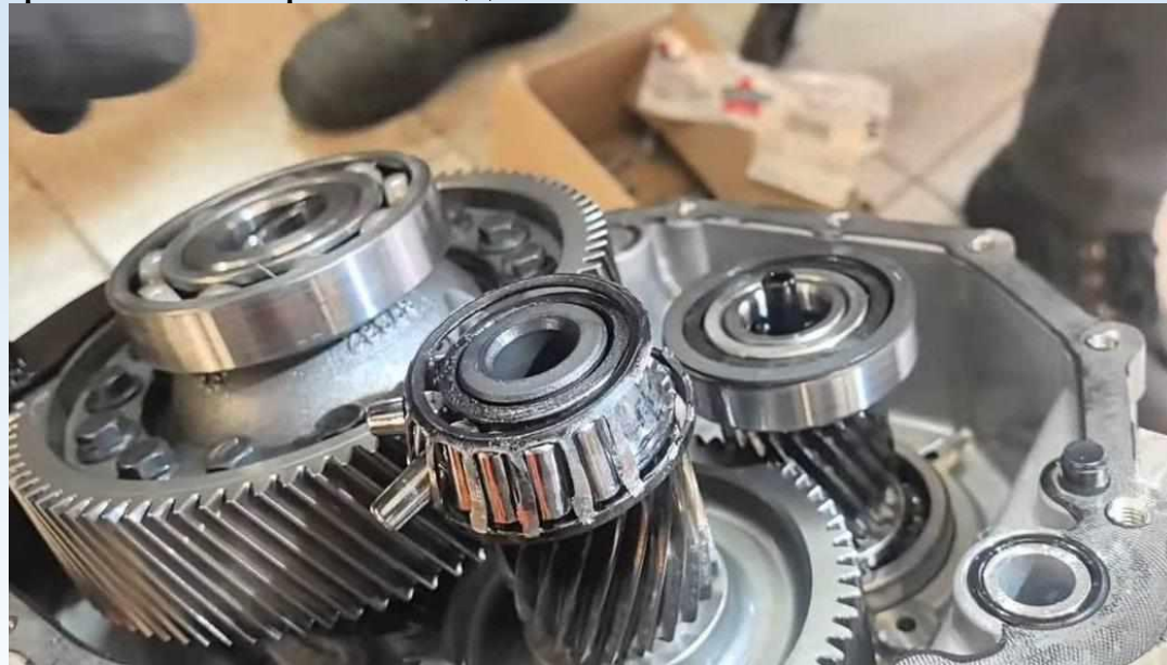
Износ подшипника в редукторе
