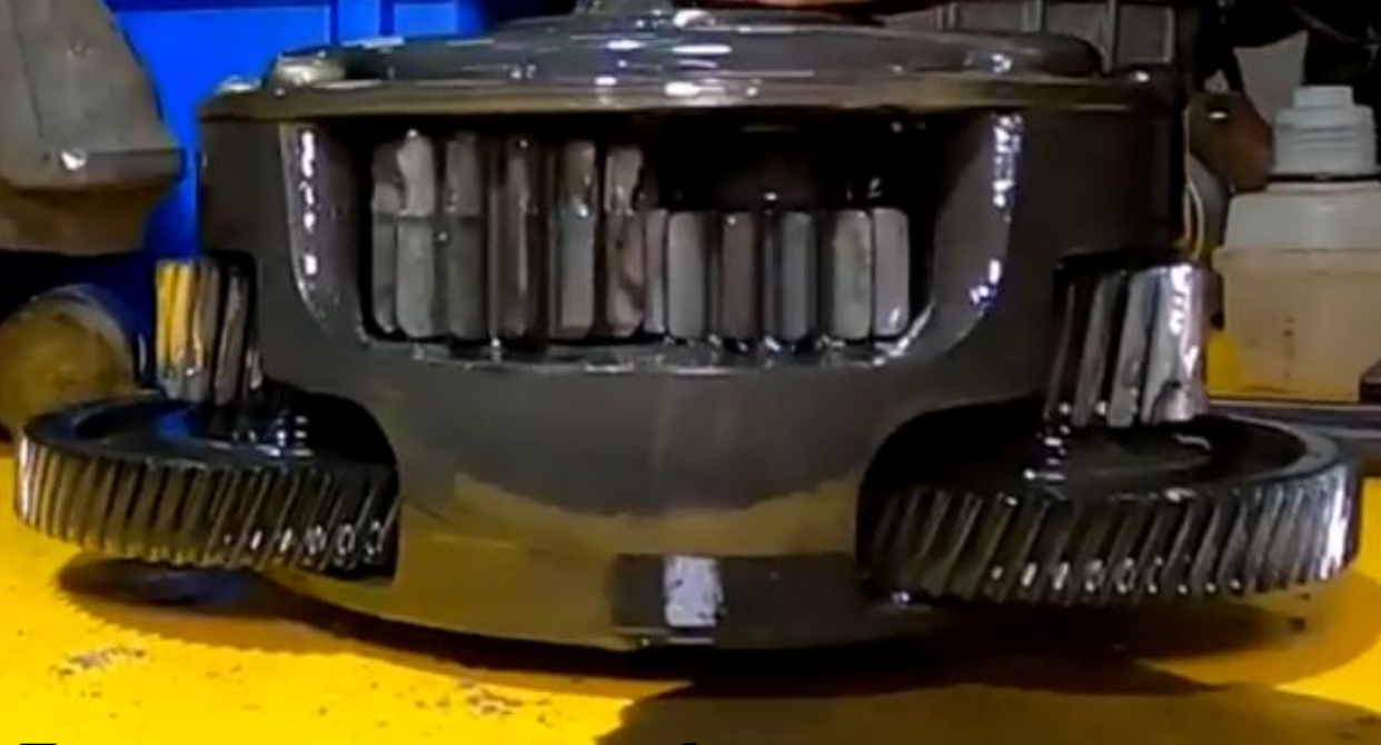
Пример выкрашивания зубьев редуктора в результате агрессивного режима движения
