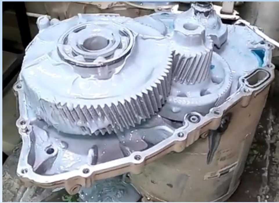
Результат смешивания масла и охлаждающей жидкости в редукторе
