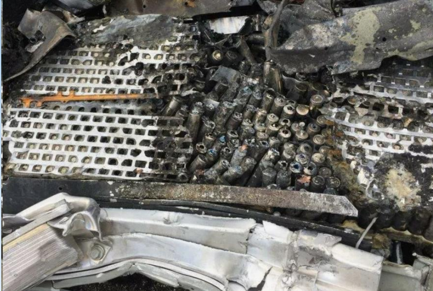
Механическое повреждение силовой АКБ вследствие аварии
